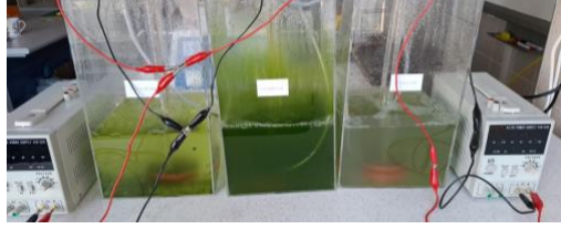
Şekil 6: Chlorella sp., Scenedesmus sp. ve Spirulina kültürü için kurulan biyoreaktörler
